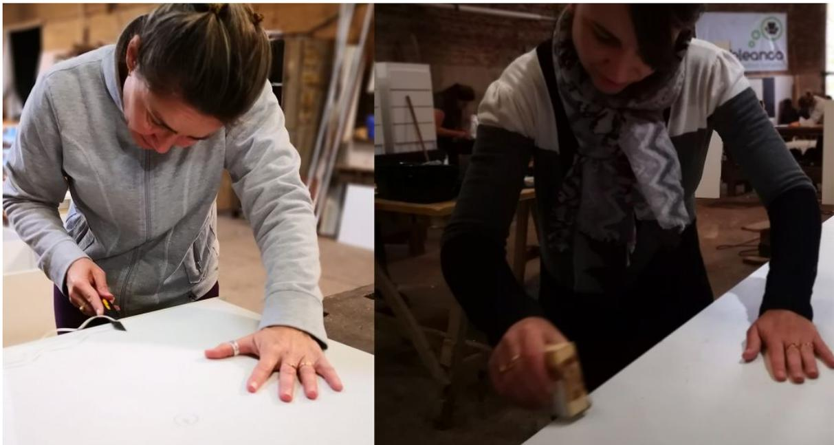
Si nos quedó mal pegado podemos sacarlo y colocar otro. Para sacarlo volvemos a calentarlo con la plancha y lo vamos a ir levantando hasta sacarlo completamente. No necesitamos lijar ni sacar el adhesivo que haya quedado en la pieza de melamina.
