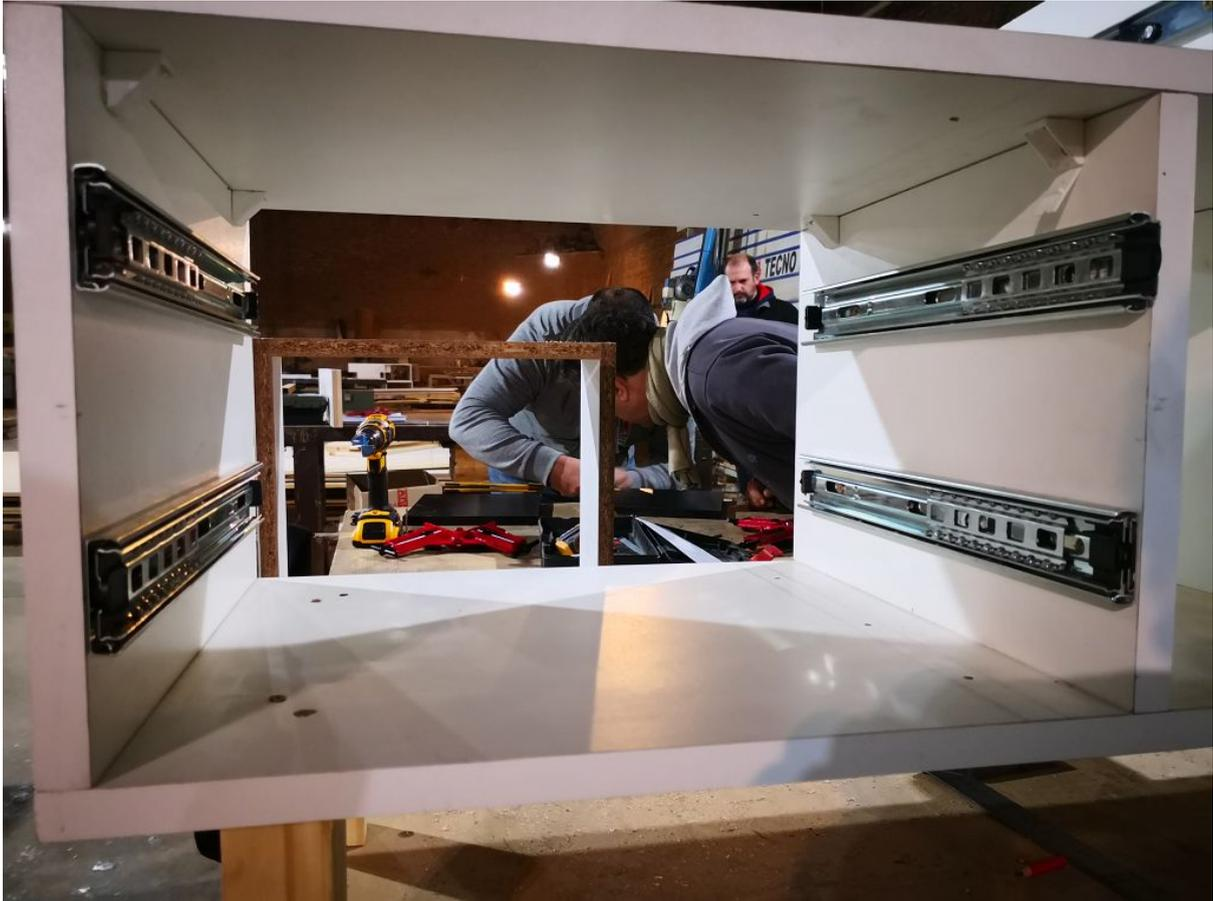
Las correderas telescópicas tienen dos partes, una va a la estructura de la cajonera y la otra al cajón. Tienen varios agujeros. Podemos usar cualquiera de ellos para amurarla.
